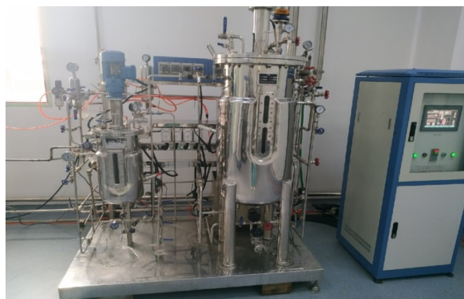
2-сурет. BlBio (Шанхай BaiLun Bio-technology Co, Ltd., Қытай) биореакторы
